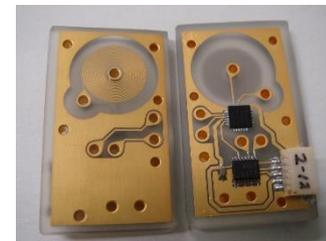
基板を低熱膨張ガラス、回路を金メッキ、読み出し発振数のカウントアルゴリズムを変更
