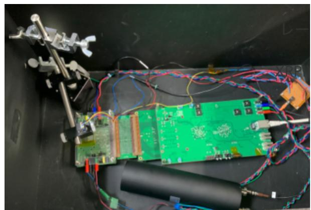
図 3: 実験の実際のセットアップ。読み出しボードの上にレーザーを固定し、光電子増倍管でレーザーの散乱光を検出している。
