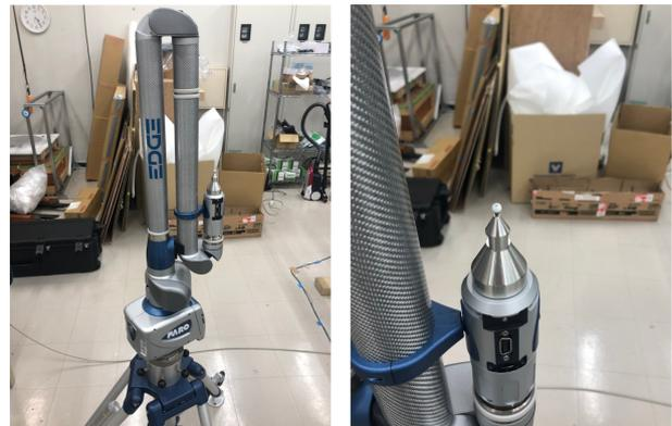
図 7: (左) 使用する三次元測定機 (右) 三次元測定機の先端
