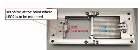
図 7: LEO はそれぞれ 3 点で支持され、左側の赤丸で囲まれた LEO2 の下になるフレーム部分にシムプレートを設置しかさ上げにより位置調整をおこなった。
