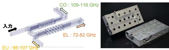
図 5: Triplexer のモデル図と写真
