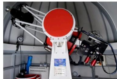
図 1: 40cm 可視光測光・分光望遠鏡「PHAST」。
