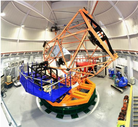
図 1: せいめい望遠鏡の支持構造 (Kurita et al. 2020) より引用
