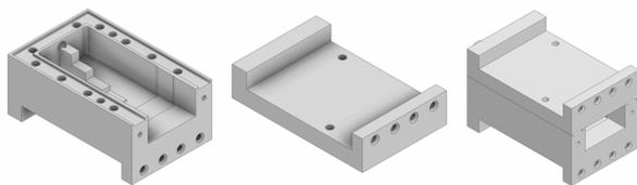
図 8: 同軸導波管変換の CAD 図
