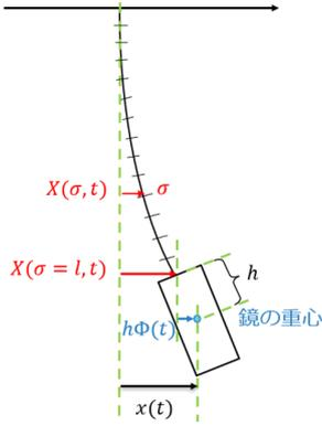
図 2: セットアップ (懸架鏡の詳細)
