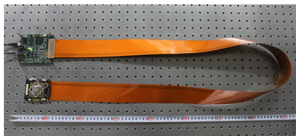
図 3: 開発した新しいフラットケーブルによる、SIDE CAR ASIC の動作試験。JADE2 Card と接続し、SIDE CAR ASIC の認識とフレーム取得ができることを確認した。
