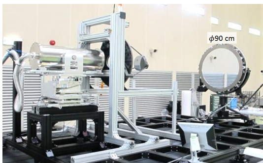
図 4: 直径 90 cm の平面鏡を用いたオートコリメーション法での測定。
