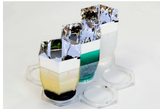
図 5: 各光検出器に取り付けられる集光鏡のプロトタイプ。鏡から反射されて来た光を光電子増倍管の管面へ導く。
