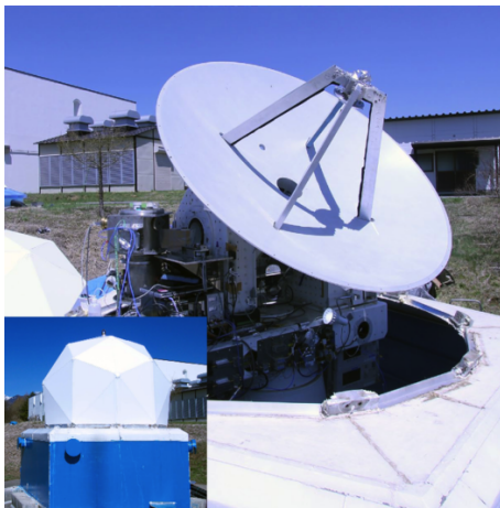
図 1: 長野県野辺山宇宙電波観測所に設置されている 1.85 m 電波望遠鏡。観測時は風や温度変化による影響を抑えるため、レドームに覆われている (左下)。
