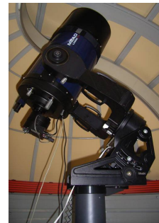
図 1: 観測に使用する口径 30cm の望遠鏡及び赤道儀 (Meade LX200-30GPS)
