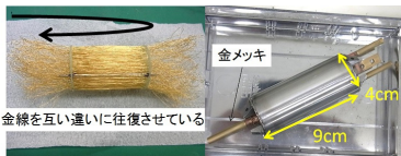
図 6: 磁性体カプセル内部と完成品
