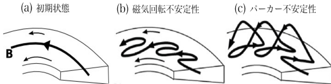
図3: Nishikori et al. (2006) による円盤ダイナモの模式図。(a) 簡単な初期状態として方位角方向にのみ磁場が存在、(b) 磁気回転不安定性により方位角方向の磁場が増幅、(c) パーカー不安定性による方位角磁場の浮上と磁気ループの形成。(c) の円盤内部に残された逆向きの磁場が (b) によって増幅される事で (c) が起こり…と、(b) と (c) を準周期的に繰り返す。
